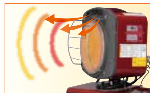
楕円形のディスクから大量の赤外線とサーキュレーターから出る温風のW効果で周囲を温めます。
