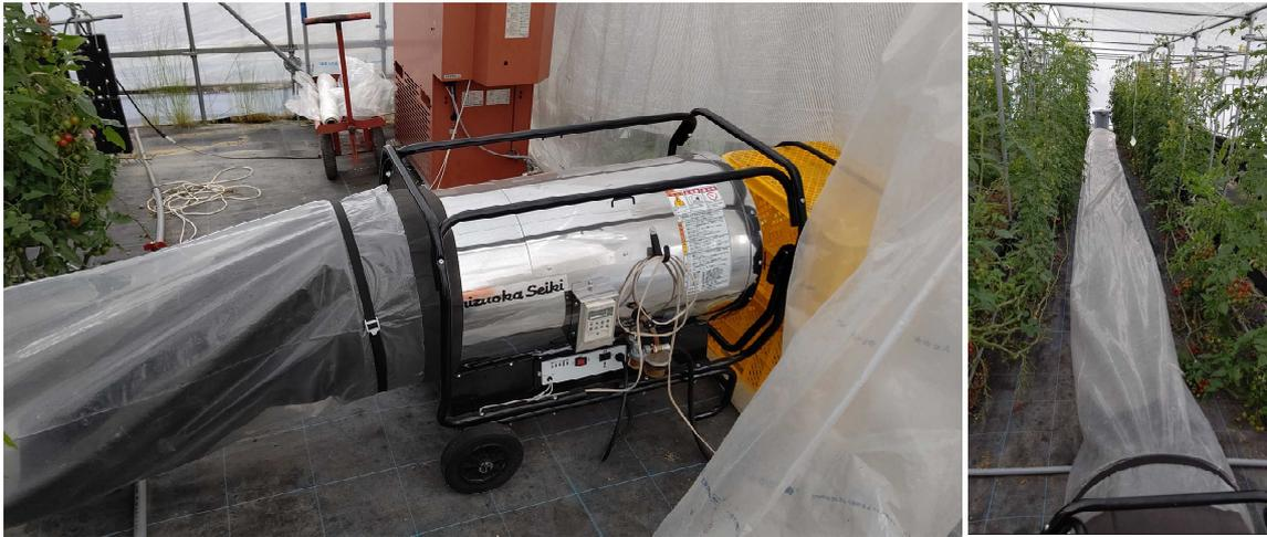
図1 炭酸ガス発生装置「CG-1000」の設置および稼働状況
