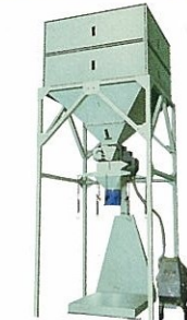
フレコン計量機
