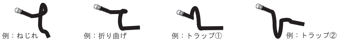
図3-4-3 好ましくない給油ホースの状態の例
