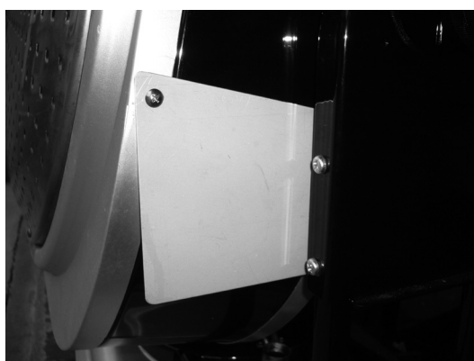
上記部品は、梱包時の固定用金具です。プロテクター取り付け時に取り外しすぐに廃棄してください。
