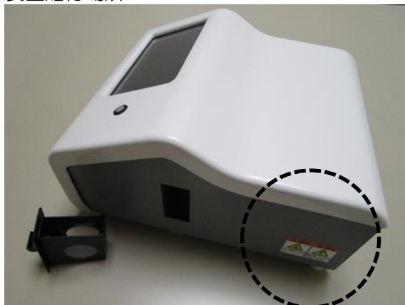
装置貼付場所
