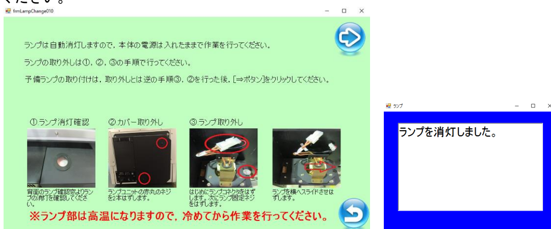
図 8.7.4.1 ランプ交換作業画面
