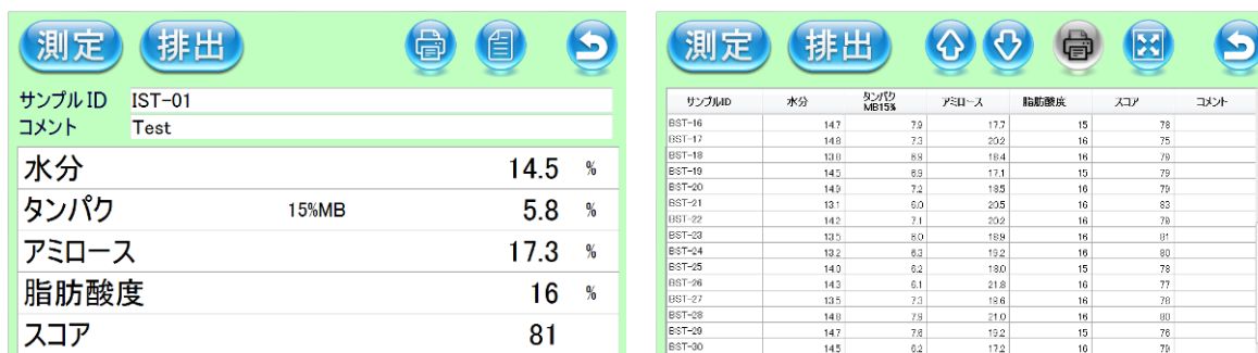
図 8.4.1 サンプル測定結果画面（左：測定結果拡大表示、右：測定結果リスト表示）
