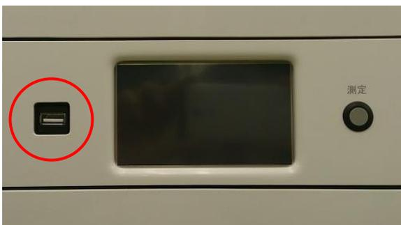
前面USB-AポートにUSBメモリを挿してデータの移動、プログラムの更新を行います。
