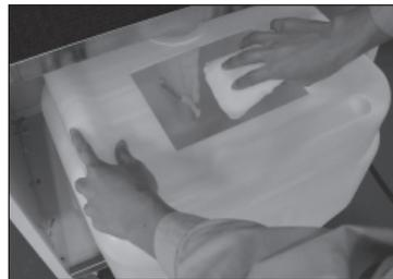
3 タンクを元の位置に確実に取り付けてください。この時、タンク下部のホースが折れないよう注意してください。ホースが折れると、循環水量が減り、冷却性能が低下するおそれがあります。
