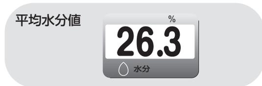
① コントロールボックスの電源スイッチを『入』にすると、自動水分計が約7秒間動きます。
