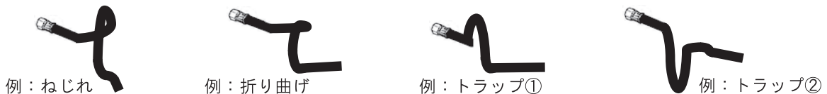
図3-1-C 好ましくない給油ホースの状態の例
