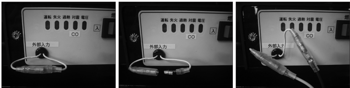
図9-1 サーモスタットの取付け方法
