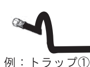
図3-1-C 好ましくない給油ホースの状態の例
