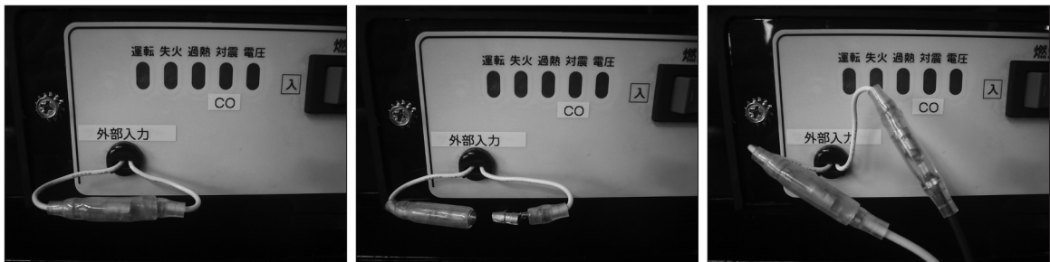
図9-1 サーモスタットの取付け方法
