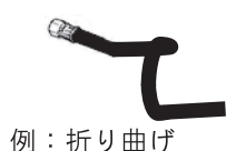
図3-1-C 好ましくない給油ホースの状態の例
